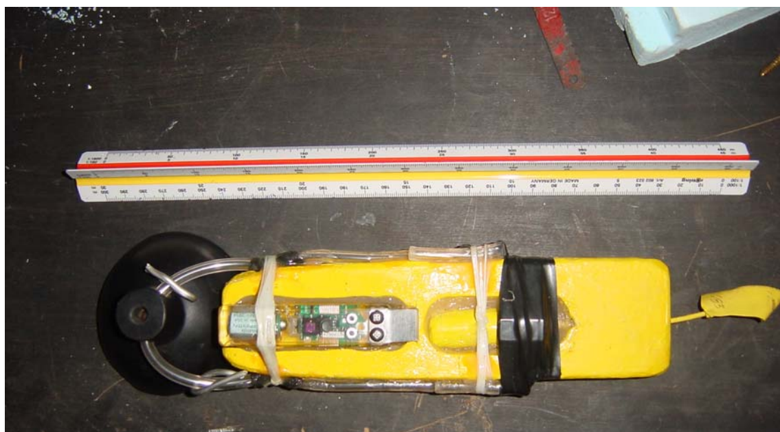
Figura 6- Transmissores construídos pelos parceiros no âmbito do projecto Macetus para serem utilizado no mesmo projecto.
